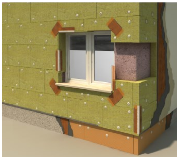
Ventilirane fasade – toplinska izolacija
