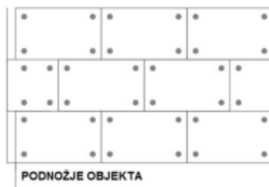
4 pričvrsnice/ploča ili 6 kom/m 2 fasade
