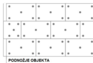
5 pričvrsnica/ploča ili 8 kom/m 2 fasade
